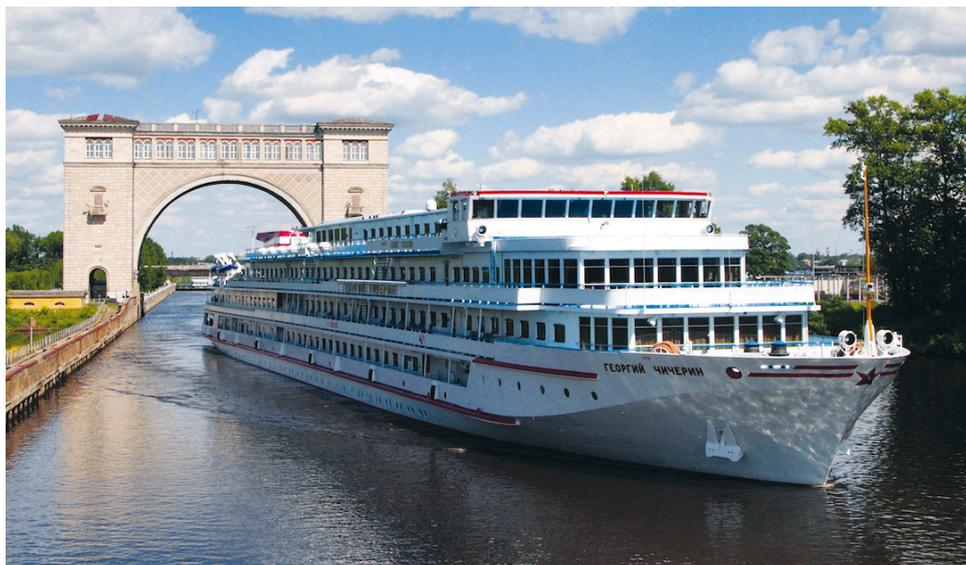
Le M/S G. CHICHERIN est un bateau de catégorie confort. Bateau type 302 à 4 ponts. Longueur : 129 m / Largeur : 16,70 m / Tirant d'eau : 2,9 m / Vitesse 26 Km/h / Capacité : 284 passagers.
